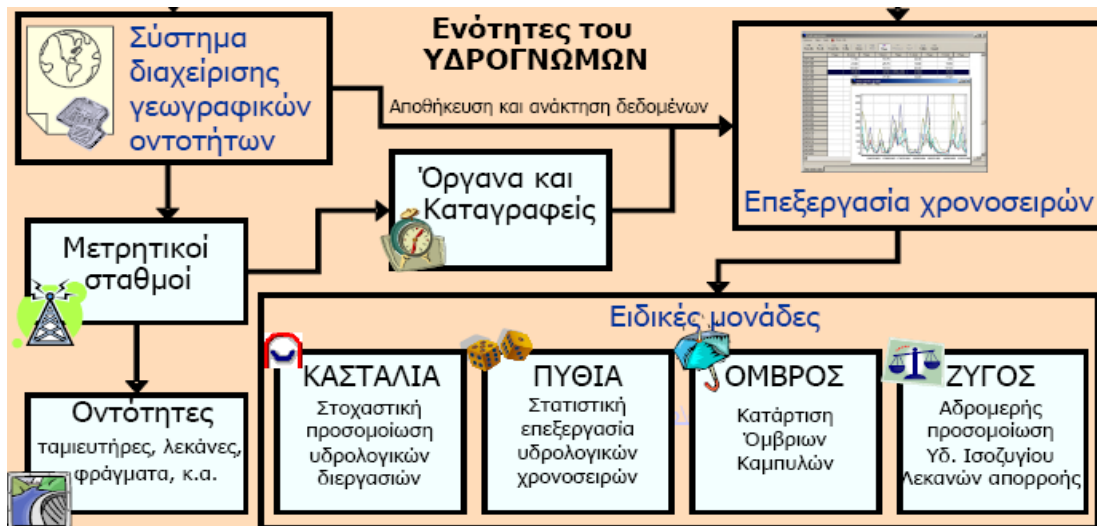
Εικόνα 3-8: Σχηματική αναπαράσταση του Συστήματος Διαχείρισης και Επεξεργασίας Χρονοσειρών «Υδρογνώμων» (Α. Ευστρατιάδης, Α. Κουτσογιάννης και Σ. Κοζάνης-2005)
